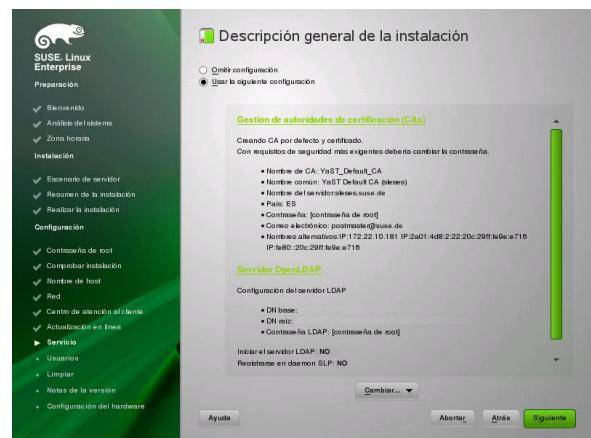
17. Por defecto, SUSE Linux Enterprise Server crea un certificado para el sistema. Para inhabilitar esta función, haga clic en *Omitir configuración* → *Siguiente*. Haga clic en *Siguiente*.
